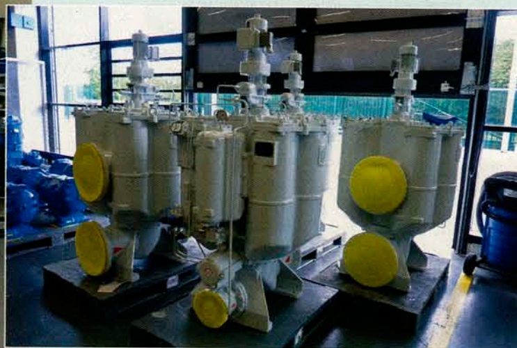
Anlagenteile wie Ventile, Pumpen und Lager werden mit Bollfilter vor Verschmutzung und Verschlämmung bewahrt (links)
