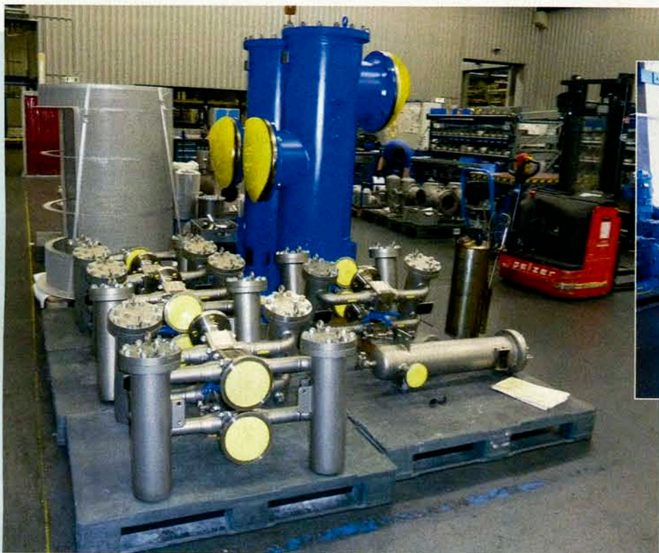
Anlagenteile wie Ventile, Pumpen und Lager werden mit Bollfilter vor Verschmutzung und Verschlämmung bewahrt (links)
